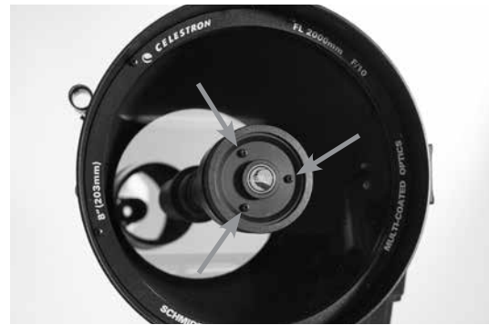
Collimazione dello specchio secondario regolando le vite
