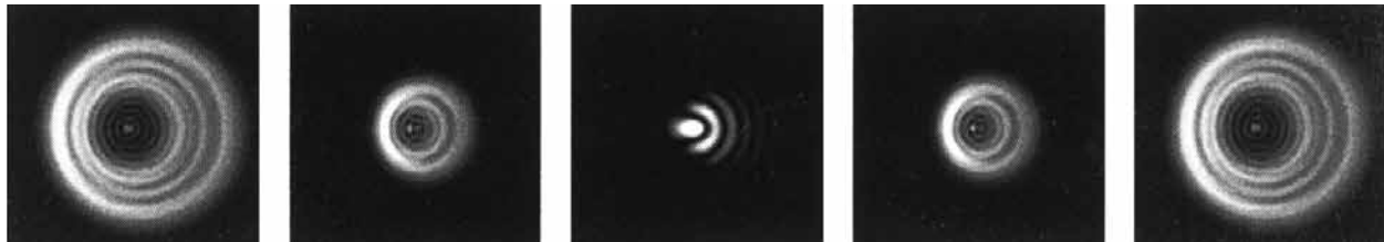
Collimazione dello specchio secondario regolando le vite
