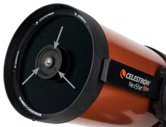
Collimazione dello specchio secondario regolando le viti
