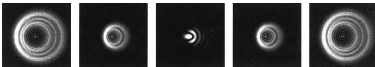
Collimazione dello specchio secondario regolando le viti
