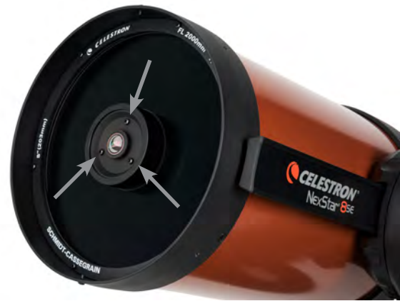
Tornillos de ajuste de colimado del espejo secundario
