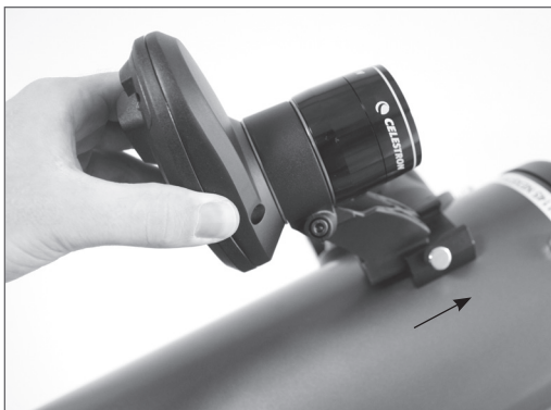
Installation du petit support (arrière vers avant)
