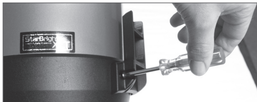
Installation avec un tournevis cruciforme
