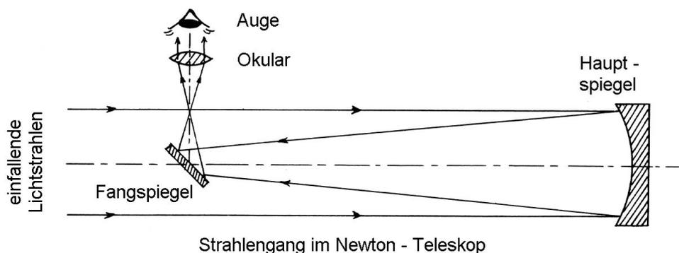
**Das einfallende Lichtbündel** kommt von links und trifft auf den Hauptspiegel am Ende des Tubus, wird dort reflektiert, trifft auf den Fangspiegel und wird von dort im rechten Winkel aus dem Tubus heraus – über das Okular – in das Auge des Beobachters gelenkt.
