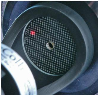
Sehen Sie ein solches Bild auf der Gitterkreuzplatte, dann verstellen Sie den Hauptspiegel so lange, bis der reflektierte Strahl durchs Loch fällt und somit in sich selbst reflektiert ist.
