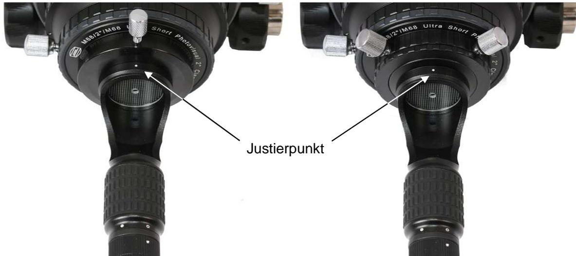
Die weiße punktförmige Markierung (Justierpunkt) sollte in einer Linie mit der Klemmschraube in der Okularsteckhülse liegen (siehe auch Abbildung oben links). Hat Ihre Okularsteckhülse zwei Klemmschrauben unter 120 Grad, sollte der Justierpunkt mittig dazwischen liegen (siehe auch Abbildung oben rechts).
