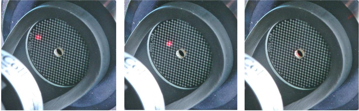
Mit den Stellschrauben den Hauptspiegel so lange kippen, bis der Laserpunkt durchs Loch in sich selbst reflektiert wird. Fertig, Ihr Newton ist perfekt kollimiert. Eine endgültige Kontrolle der Kollimation muss dann am Stern erfolgen (siehe nächste Bilder).
