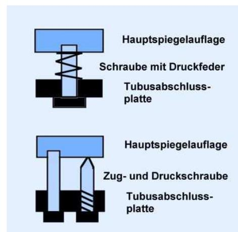
Die Federverstellung ist leichter und einfacher zu bauen und auch leichter zu bedienen. Die Federspannung kann sich aber leicht ändern, was eine sofortige Dejustierung des Hauptspiegels zur Folge hat. Deshalb werden sie nur in kleineren Spiegelteleskopen eingebaut.
