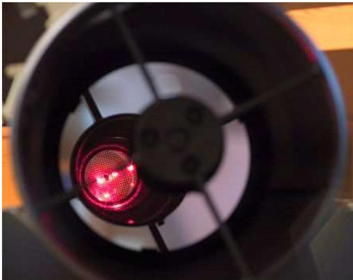
Schauen Sie dazu von vorn in den Tubus hinein. Sie sehen dort auf dem Hauptspiegel eine Reflexion des Fangspiegels (und der Gitterplatte des Laser-Colli™ Mark III) und auf ihm die mehrfache Reflexion des Laserlichtpunktes.
