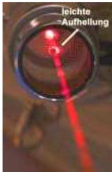
Da der Laserstrahl fast genau so groß ist wie das kleine Loch in der Glasscheibe mit dem Kreuzgitter, ist es bauartbedingt möglich, dass der Laserstrahl den Rand des Loches leicht streift.
