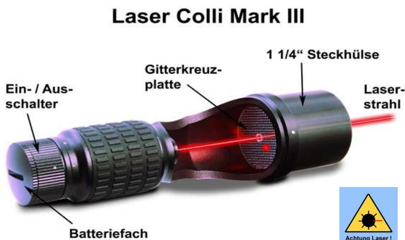
Voraussetzung dafür, dass der Laser-Colli™ zuverlässig funktioniert, ist natürlich, dass der Laserstrahl genau mittig durch die Steckhülse austritt.
