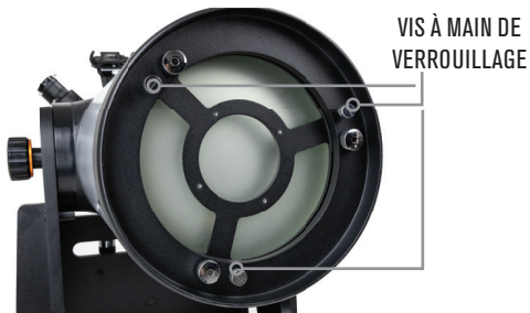
Figure 21: Pour les Dobsoniens de 10 et de 12, il se trouve trois vis de serrage à ressort qui règlent l'inclinaison du miroir principal. Les trois autres vis à main verrouillent le miroir en place une fois les réglages d'inclinaison terminés.
