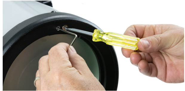
Figura 20: Para el Dob de 8", dispone de tres grupos de tornillos de empuje-tiro en la célula del espejo que ajustan la inclinación del espejo primario. Afloje un tornillo del par y apriete el otro para ajustar la inclinación.
