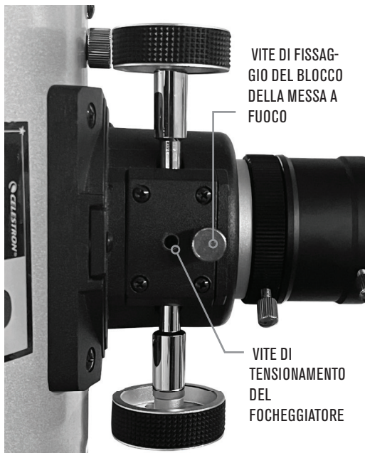
Figura 5: la vite di blocco della messa a fuoco blocca il foceggiatore in posizione una volta raggiunta la messa a fuoco. La vite di tensionamento della messa a fuoco regola la tensione delle manopole di messa a fuoco.
