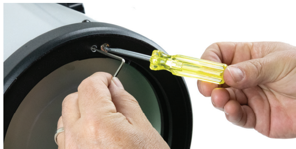
Figura 20: per il dobson 8", sono presenti tre set di viti push-pull nella cella dello specchio che regolano l'inclinazione dello specchio primario. Allentare una vite della coppia e serrare l'altra per regolare l'inclinazione.
