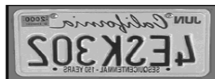
Orientación de la imagen invertida de izquierda a derecha observada a través de un prisma cenital
