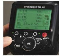
Zentrale Steuerung vom Display des Master-Blitzgeräts. Einstellen des Blitzmodus, Aktivieren oder Deaktivieren von Blitzgerätegruppen, Steuerung der Blitzbelichtungskorrektur von bis zu drei Blitzgerätegruppen.
