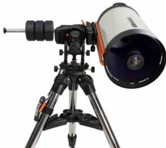
Figura 6 Equilibrado del soporte
