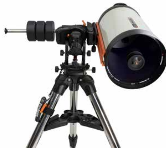
Abbildung 6 Ausbalancieren der Montierung
