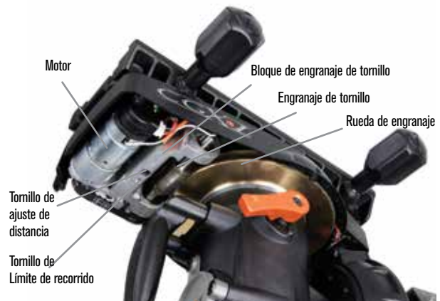
Figura 14 Encaje del engranaje de tornillo
