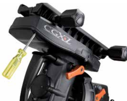
Figure 13 Retirer le cache d'engrenage
