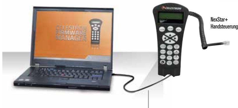
Abbildung 12.2 Aktualisieren der Handsteuerungs-Firmware
