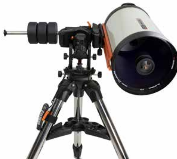
Figura 6 Bilanciare la montatura
