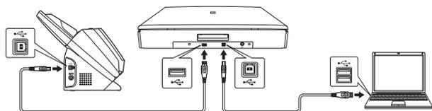
Si vous utilisez le scanner DR équipé d'un adaptateur secteur, raccordez la glace d'exposition Flatbed 201 entre le scanner DR et le PC.
