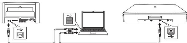
Quando si utilizza lo scanner DR con alimentatore integrato, collegare lo scanner piano Flatbed 201 e lo scanner DR direttamente al PC
