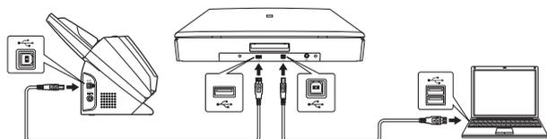
Quando si utilizza lo scanner DR con adattatore CA, lo scanner piano Flatbed 201 va collegato fra lo scanner DR e il PC
